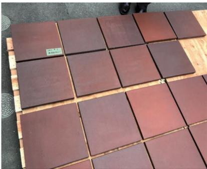
写真は、何度も試作検討を経てようやく完成したタイルを、新築時から使わずに保管されていたタイル、解体工事によってエスプラナードから取り外したタイルと並べ、色彩やテクスチャーが再現できているか見極めているところです。福岡市美術館のタイルは目地を含んで32cm角。当館の展示棟は32m角を基準としており、その100分の1のサイズとして規定されました。これは既製のタイルよりもやや大きいため、特注品となります。数cm大きくなるだけで、製造過程で割れやすくなり反りやすくなるそうです。丁寧な検品を経てここまでたどり着いたタイルは、精鋭タイルと呼んでもいいかもしれません。焼き物特有の風合いとこだわりのサイズに注目しながら、開館後は踏みしめてみてください。
